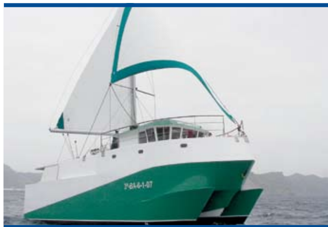
Buque de pesca con propulsión auxiliar mediante velas convencionales. Cortesía de Astilleros Mercurio Plastics, S.L. ( www.mercurioplastics.com )
