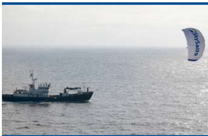
Sistema de propulsión auxiliar mediante cometas. © 2008 Skysails GmbH ( www.skysails.de )
