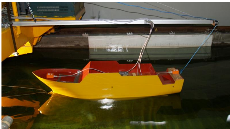
Figura 2: Disposición del modelo durante los ensayos en canal de experiencias.
