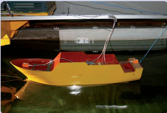
Figura 2. Disposición del modelo durante los ensayos en canal de experiencias.
