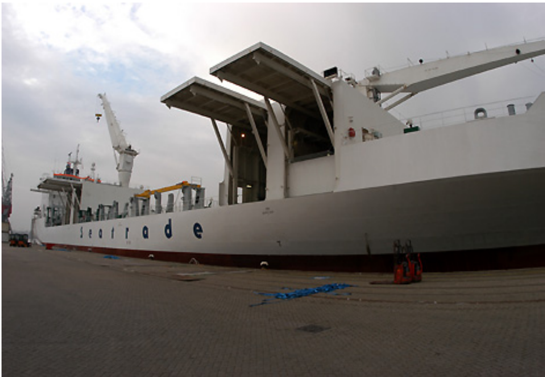
Buque frigorífico dotado de rampas laterales
